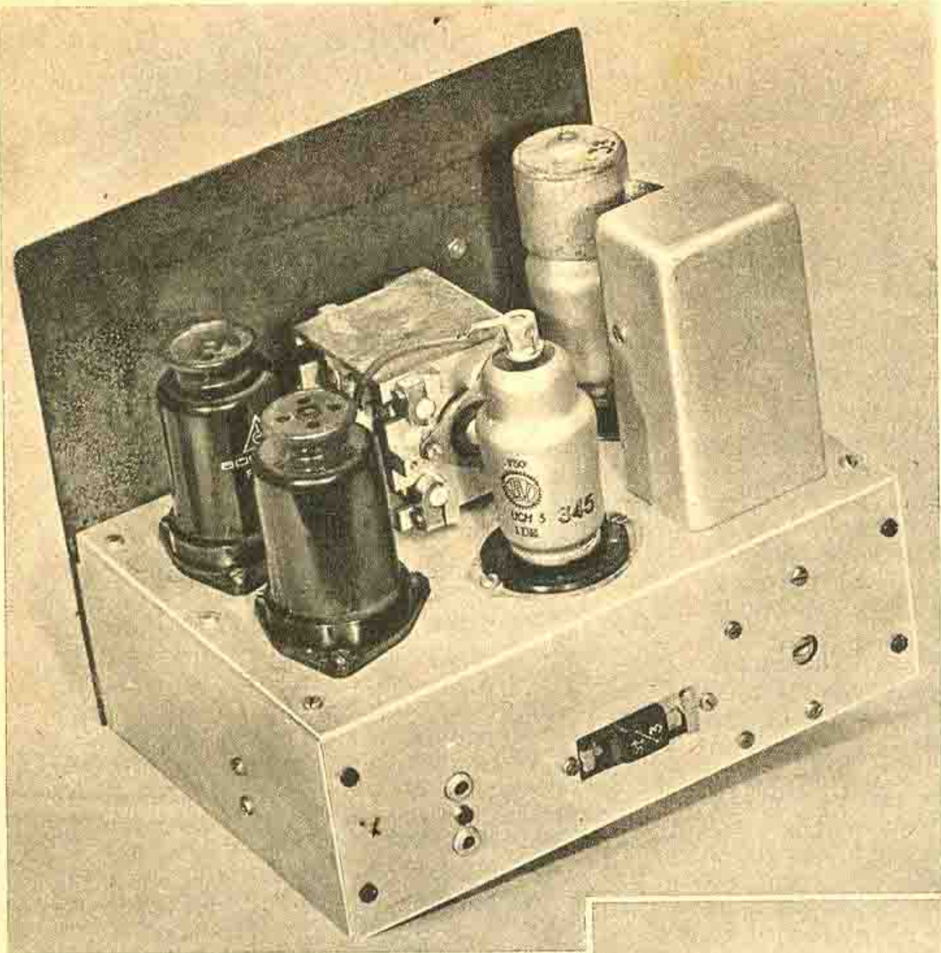
Abb. 1. Erste Baustufe des Zweiröhrenkleinsuperhets. Abb. 2 (rechts). Die Verdrahtungsansicht des gleichen Gerätes
